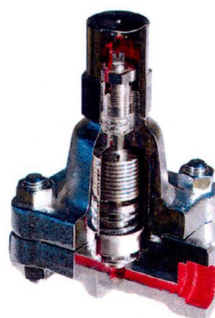
Рис.18. Биметаллический КО, управляемый по температуре (разрез).
